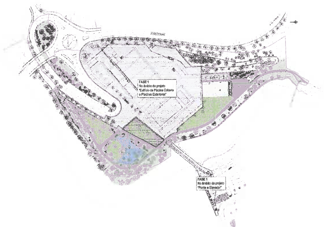
Figura 1 - Planta geral do faseamento construtivo: Fase 1 – assinalada a cinza; Fase 2 – assinalada a cores.
