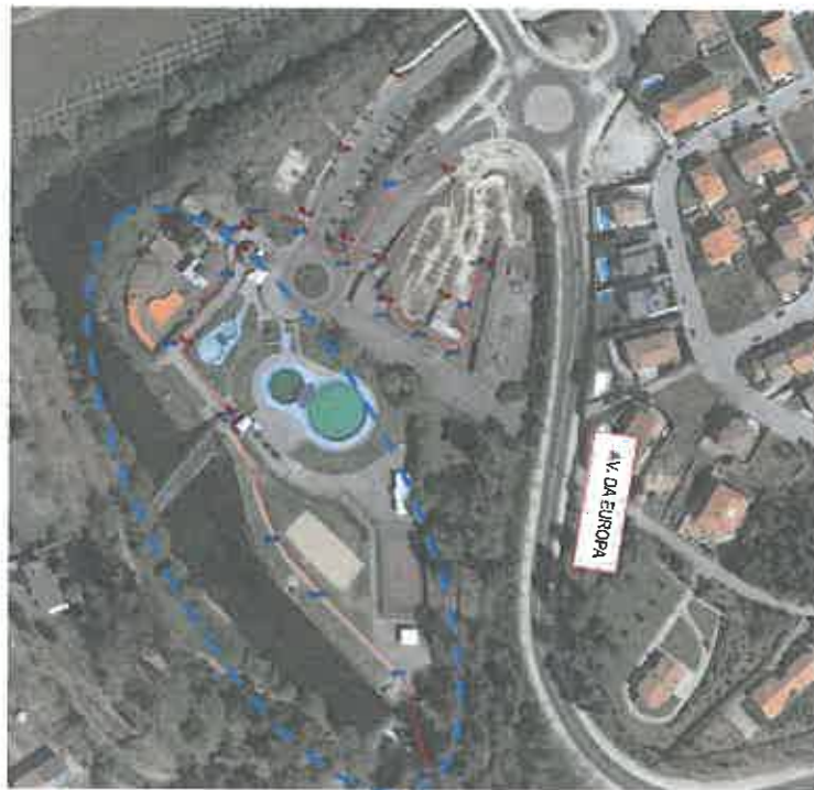
Figura 13 - Complexo Codessais – Cadastro de águas pluviais
