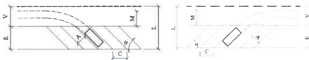
Figura 25 – Parâmetros geométricos para definição dos lugares de estacionamento adjacentes à via pública (fonte CCDRN, 2010) a) estacionamento no sentido da marcha; b) estacionamento de marcha-a-trás
